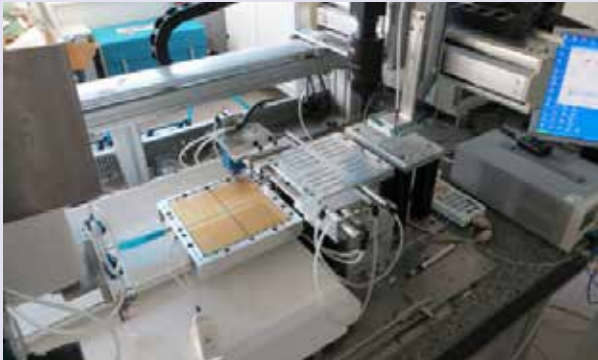
Robot d'assemblage d'unités de détecteur permettant le positionnement et le collage des capteurs sur les cartes électroniques de lecture.
