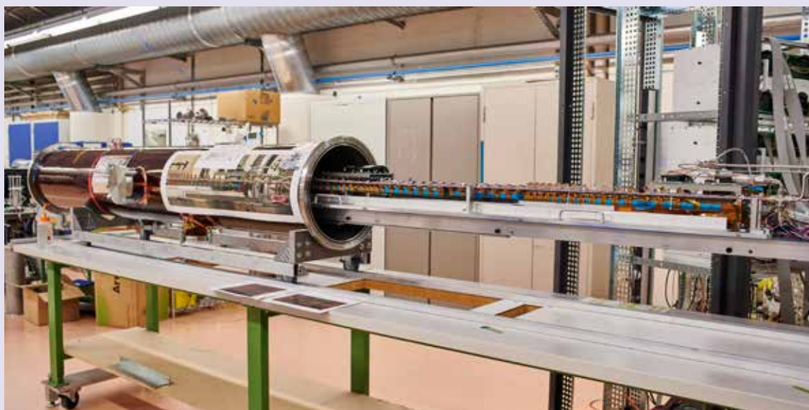
Prototype du nouveau détecteur à pixels de l'expérience ATLAS. Ce futur détecteur à pixels sera un des éléments du nouveau détecteur de traces interne (ITk) tout en silicium qui est actuellement en cours de développement.
