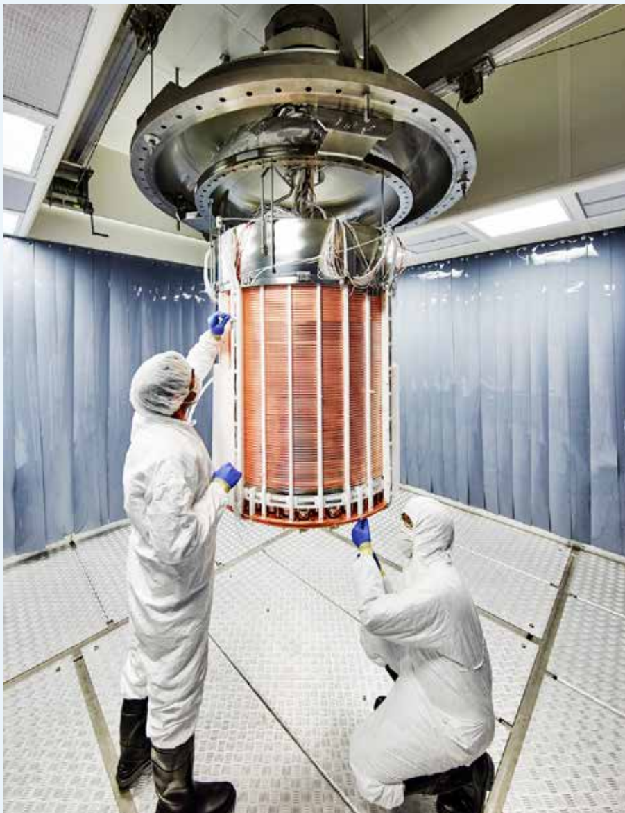
Installation de la TPC de XENON1T dans les sous-sols du Laboratoire Nationale du Gran Sasso (LNGS).
