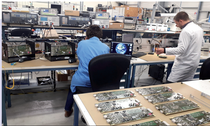
Production des FEB chez le sous-traitant. Les bancs de test des FEB, conçus au LPNHE, sont déployés sur le site de production afin de valider systématiquement chaque carte.
