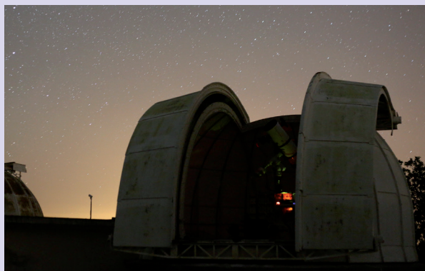
Prototype du télescope robotique StarDICE mis en place pour la démonstration d'intérêt de l'expérience. Le prototype a effectué 20 nuits d'observations, étalées sur une période de 6 mois, allant et venant de l'étoile artificielle à des étoiles standards dans le ciel.
