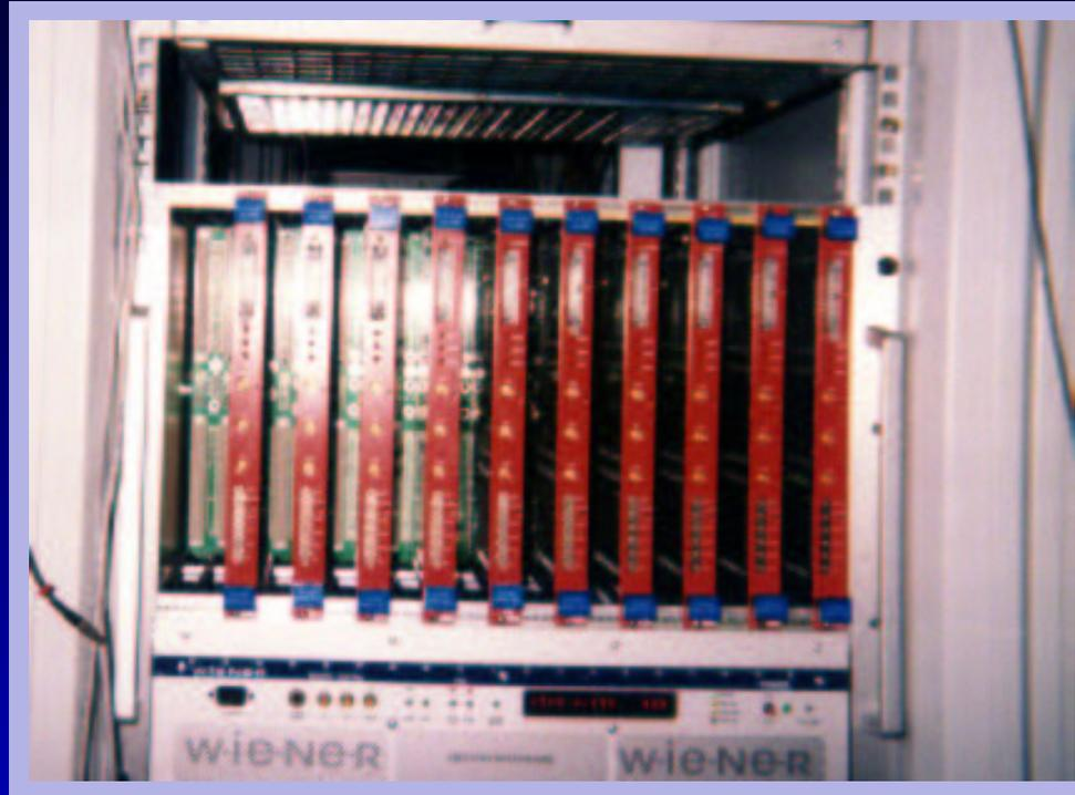
**Implantation de 34 cartes FADC dans l'électronique Borexino**
